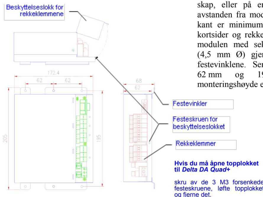
*Delta DA Quad+* kan monteres i skap, eller på en plan vegg der avstanden fra modulen til eventuell kant er minimum 10 cm både på kortsider og rekkeklemmeside. Fest modulen med seks egnede skruer (4,5 mm Ø) gjennom hullene på festevinklene. Senteravstandene er 62 mm og 195 mm. Tilpass monteringshøyde etter behovet.
